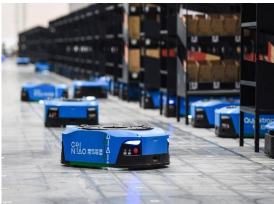
车间和仓库AGV物料自动搬运
