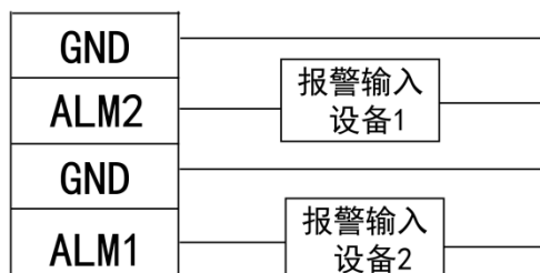
图2-14 外部报警输入接线图
